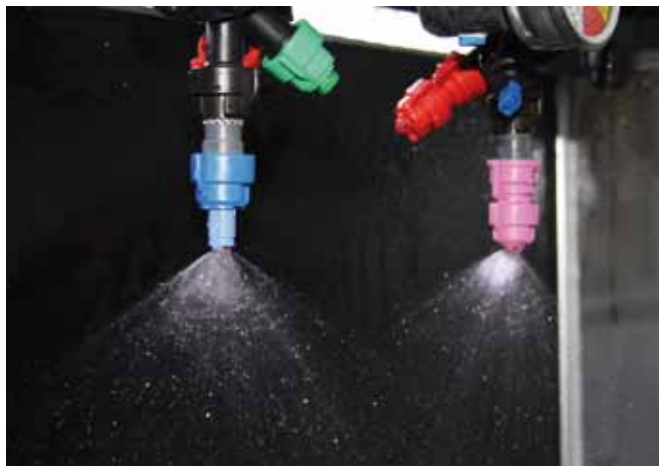
Abbildung 13: Bei der Ausbringung von Pflanzenschutzmitteln wird durch eine abdriftmindernde Düsenteknik die Gefahr von Einträgen in Oberflächengewässer reduziert.
