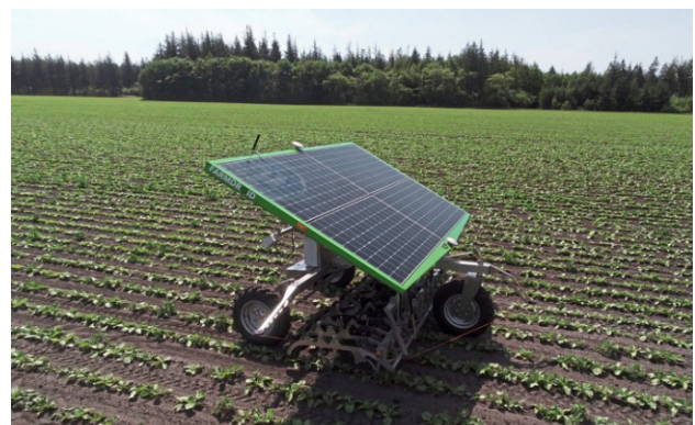
Autonomer Hackroboter der Firma „Farmdroid“ übernimmt auch die personelle und kostspielige Hacke in der Reihe bei Zuckerrüben. (Farmdroid)
