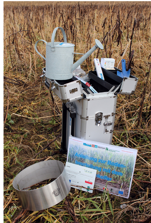
Der stabile Bodenkoffer enthält alle Geräte, die für die Bodenbeurteilung notwendig sind (Foto: LEADER-Region Mitten im Innviertel-/Atzwanger).
