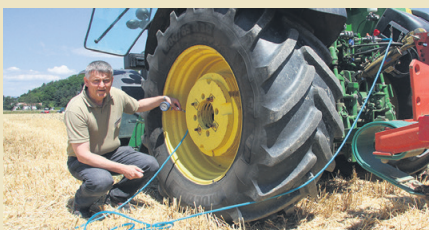
Je nach Untergrund den richtigen Reifendruck wählen und Treibstoff sparen. Wolfesberger
