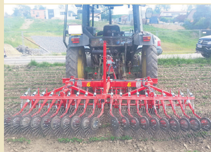
Durch die schräg gestellten Sterne ist eine flächige Bearbeitung möglich.
