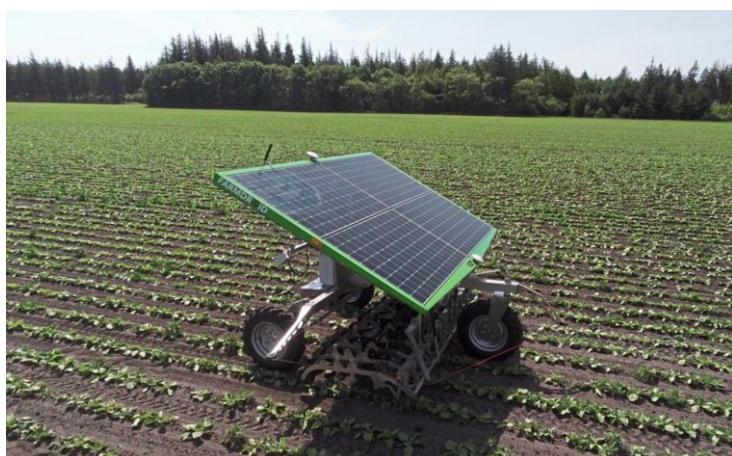
Autonomer Hackroboter der Firma „Farmdroid“ übernimmt auch die personelle und „kostspielige“ Hacke in der Reihe bei Zuckerrüben. (Farmdroid)
