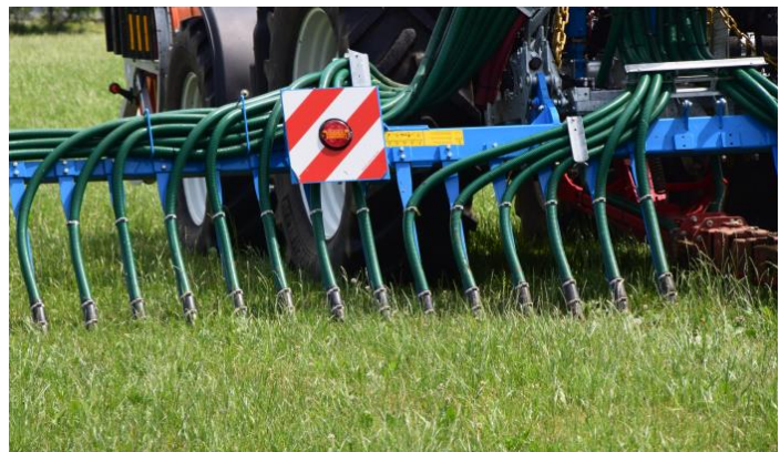
Für Grünland und Feldfutter wird vorrangig die Schleppschuh-technik empfohlen (weniger Futtermittelverschmutzung, längerer Ausbringungszeitraum). Foto: Dipl.-Kfm. (FH) DI (FH) Helmut Scherzer, Geschäftsführer, VLÖ (Vereinigung Lohnunternehmer Österreich)
