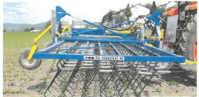
Indirekt gefederte Zinken haben einen konstanten Druck über den gesamten Hebelweg – Vorteil vor allem bei Dammkulturen. BWSB
