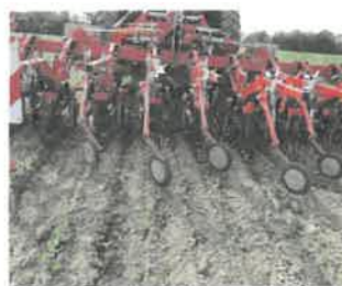
Rollstriegelelemente ermöglichen eine direkte Bearbeitung in der Reihe. BWSB
