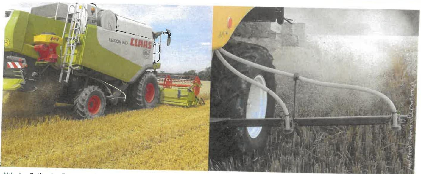
Abb. 4: Optimaler Erosionsschutz durch Mähdruschaat.
