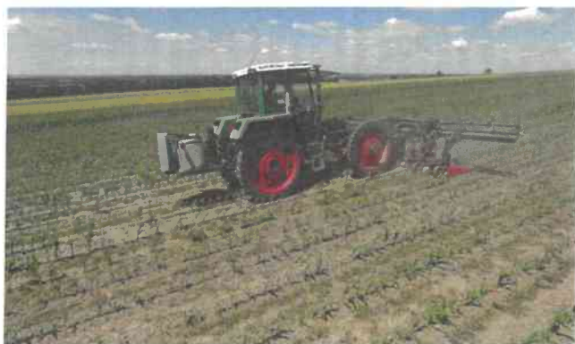
Abb. 6: Der von Rohringer & Rossak entwickelte Zwischenreihenmulcher im Einsatz
