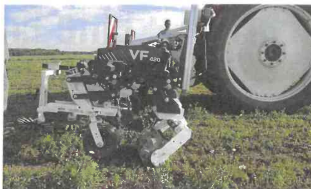
Abb. 7: Mit Messerhackelementen ausgestattetes Hackgerät von Dickson-Kerner
