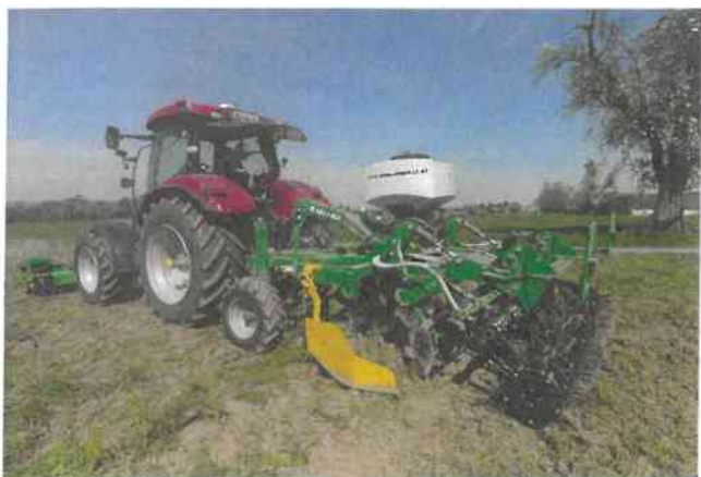
Abb. 1: Mit Stützrädern und Striegelwalze ausgestatteteter Exaktgrubber (Kerner). Die Messerwalze X-Cut solo im Frontanbau zerkleinert die Biomasse und dient zusätzlich als „aktives“ Frontgewicht
