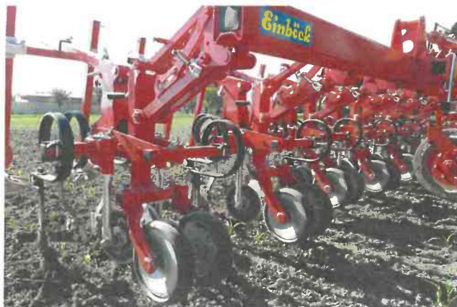
Abb. 3: Das Hackgerät „Chopstar Twin“ von Einböck ist mit Räum-scheiben und Winkelmessern zur Bearbeitung des Bereiches direkt neben der Kulturpflanzenreihe ausgestattet.
