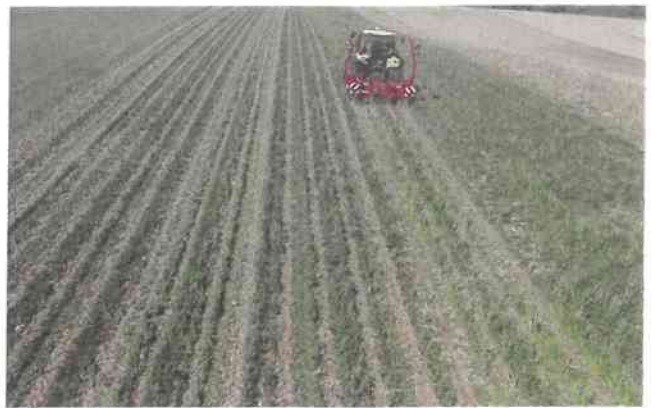
Abb. 4: Bearbeitung der künftigen Maisreihe mit dem Strip-Till-Gerät. Im Zwischenreihenbereich wird der Wickroggenbestand mit der Messerhacke in mehreren Durchgängen bis zum Reihenschluss sukzessive umgebrochen.
