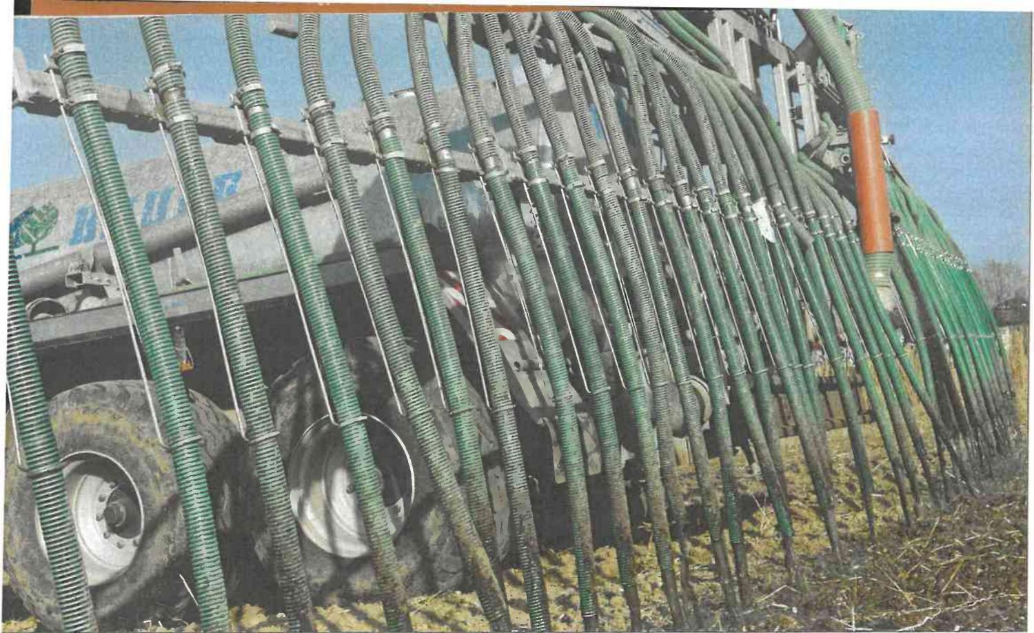
Die bodennahe streifenförmige Ausbringung erlaubt es, in Grünland- und Acker(futter)bestände Gülle möglichst verlust- und verschmutzungsarm auszubringen.
