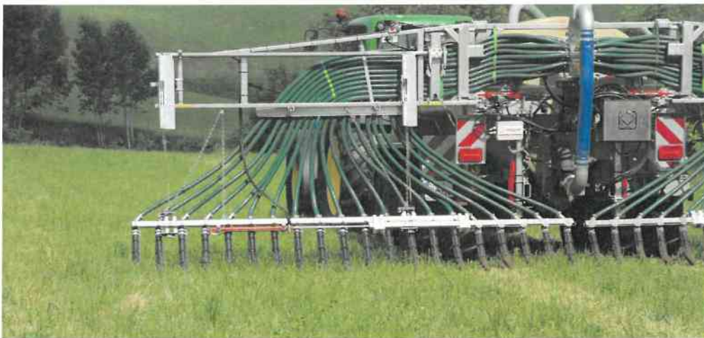
Die Ausbringung von separierter Gülle mittels Schleppschuh in einen angewachsenen Bestand reduziert die Ammoniakverluste und verbessert die Futterqualität.
