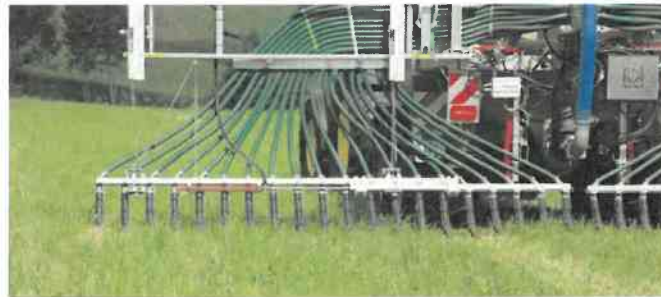
Ohne eine möglichst breite Anwendung der bodennahen streifenförmigen Ausbringungstechnik ist die Zielerreichung der Ammoniakreduktion nicht schaffbar.
