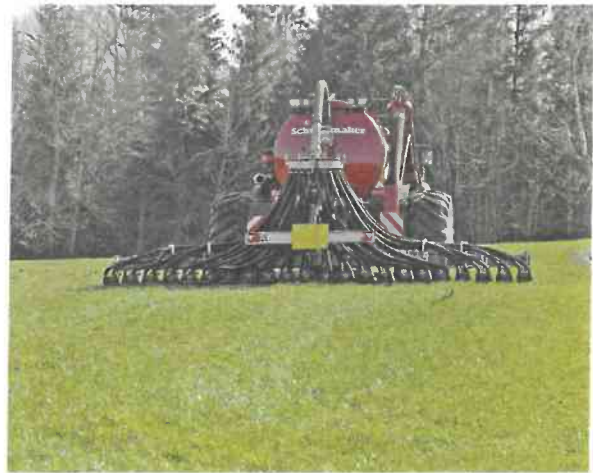
Im Grünland kann durch Einschlitung die Gefahr von Futtermittelverschmutzung vermieden werden.
