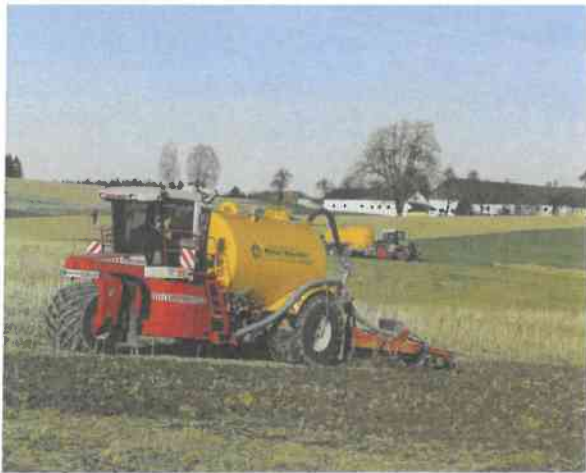
Gülle direkt in den Boden. Der Güllegrubber schafft in einem Arbeitsgang die Ausbringung und Bearbeitung des Feldes.
