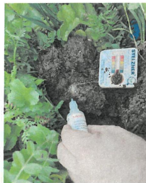
Kalkvorkommen mit pH-Meter und Salzsäure bestimmen.
