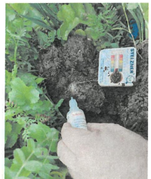
Kalkvorkommen mit pH-Meter und Salzsäure bestimmen.
