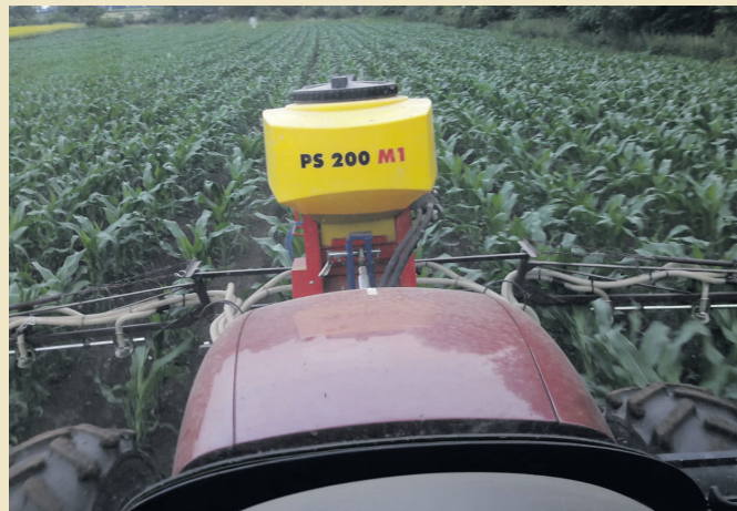
Abb. 3: Untersaatanlage mit Streuer und Schläuchen funktioniert gut.
