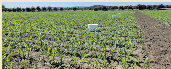
Gasförmige Stickstoffverluste werden mithilfe eines geschlossenen Kammersystems gemessen. F. KHATUN
